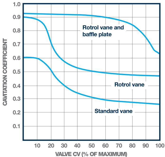
**FIGURE 11. THE ROTROL VALVE**
